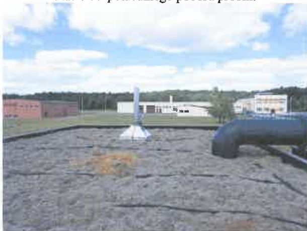
Fot. 5. Widok punktu pomiarowego B1W biofiltra nr 1, powierzchnia dyfuzyjna osłonięta ustawioną osłoną strumienia z odciąganiem do poboru próbki.
