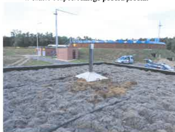
Fot. 6. Widok punktu pomiarowego B2W biofiltra nr 2, powierzchnia dyfuzyjna osłonięta ustawioną osłoną strumienia z odciąganiem do poboru próbki.
